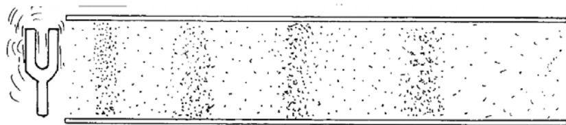
Fig. 1. El so que emet un diapasó es propaga per l'aire, o per qualsevol medi, en forma d'ones de pressió (de compressions i dilatacions). En la figura es mostra la propagació de so per un tub.
